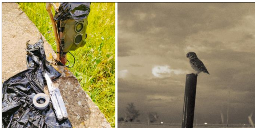
Figura 17. Pellicola scura applicata sui led di una fototrappola (a sinistra) per ridurre l'effetto di sovraesposizione ed attenuare la luminosità nelle immagini (a destra) riprese (Foto di Gabriele Stanisci).
